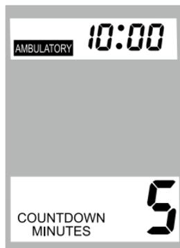
\* На экране будет отображаться обратный отсчет с X минут для указания времени, оставшегося до следующего автоматического измерения.
