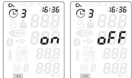
**7 Calcul de la moyenne** – L'appareil vous permet d'ignorer la 1<sup>ère</sup> mesure lors du calcul de la moyenne lorsque que le nombre de mesures sélectionné est 3, 4, 5 ou 6 mesures. Appuyez sur le bouton **Δ** ou **M** pour ACTIVER ou DÉACTIVER et appuyez sur le bouton **MODE** pour confirmer le réglage de la fonction **Ignorer 1<sup>ère</sup> mesure (d-1)** et terminer les réglages du mode AUTO. Une fois les réglages effectués, l'appareil se met en mode veille.
