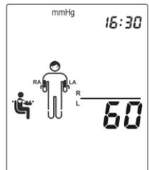
**3 Régler le Temps d'intervalle** – entre les mesures - Utilisez le bouton  $\Delta$  pour monter et utilisez le bouton  $\text{M}$  pour descendre et choisissez entre 15, 30, 60, 120, 180, 240, 300 secondes pour le **Temps d'intervalle**. Appuyez sur le bouton  $\text{MODE}$  pour confirmer et aller à l'option suivante **Détecteur AFIB**.
