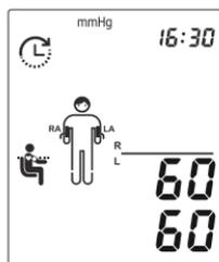
**4 AFIB-Erkennung (Vorhofflimmern-Erkennung) einstellen** – Mit den Tasten  $\Delta$ / $M$  schalten Sie die **AFIB-Erkennung** ein und aus. Drücken Sie zum Bestätigen  $\text{MODE}$ .
